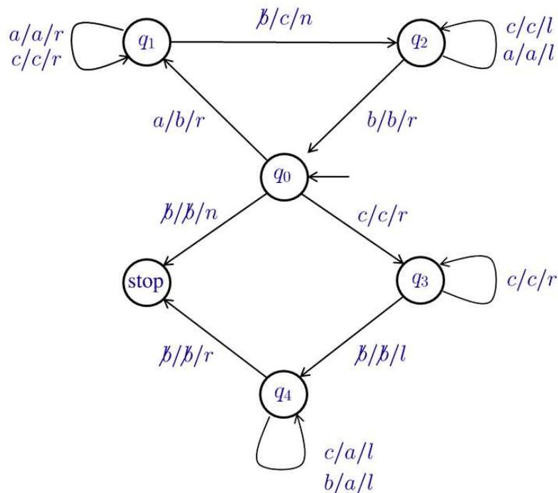
Wie bei den endlichen Automaten kennzeichnen wir den Startzustand durch einen eingehenden Pfeil und Endzustände durch einen Doppelkreis. Da obige DTM eine Funktion berechnet (im Gegensatz zu: eine Sprache erkennt), spielen die Endzustände hier jedoch keine Rolle.
