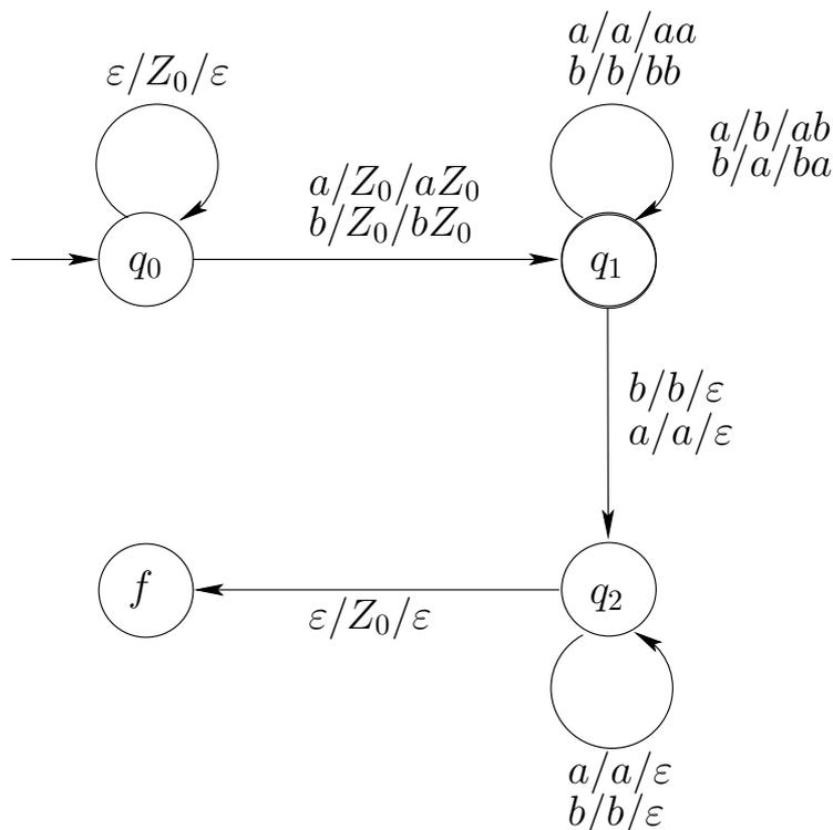
In  $q_1$  wird die erste Worthälfte im Keller gespeichert. Der nichtdeterministische Übergang von  $q_1$  nach  $q_2$  „rät“ die Wortmitte. In  $q_2$  wird die zweite Hälfte des Wortes gelesen und mit dem Keller verglichen.
