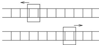
Wären die Köpfe gekoppelt, so hätte man im Prinzip nicht mehrere Bänder, sondern ein Band mit mehreren Spuren:
