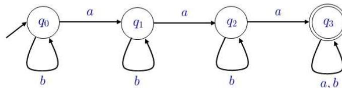
Wie im obigen Beispiel werden wir Automaten häufig als kantenbeschriftete Graphen darstellen, wobei die Zustände des Automaten die Knoten des Graphen sind und die Übergänge als Kanten gesehen werden (beschriftet mit einem Alphabetsymbol). Der Startzustand wird durch einen Pfeil gekennzeichnet und die Endzustände durch einen Doppelkreis.
