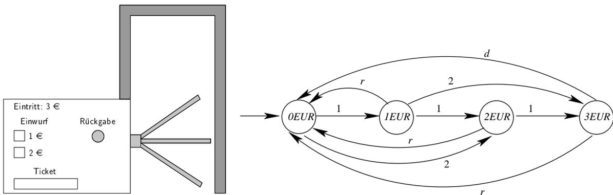
Der dargestellte Automat regelt eine Drehsperre. Es können Münzen im Wert von 1 oder 2 Euro eingeworfen werden. Nach Einwurf von 3 Euro wird die Arretierung der Drehsperre gelöst und der Eintritt freigegeben. Der Automat gibt kein Wechselgeld zurück sondern nimmt einen zu hohen Betrag nicht an (Münzen fallen durch). Man kann jederzeit den Rückgabeknopf drücken, um den bereits gezahlten Betrag zurückzuerhalten.
