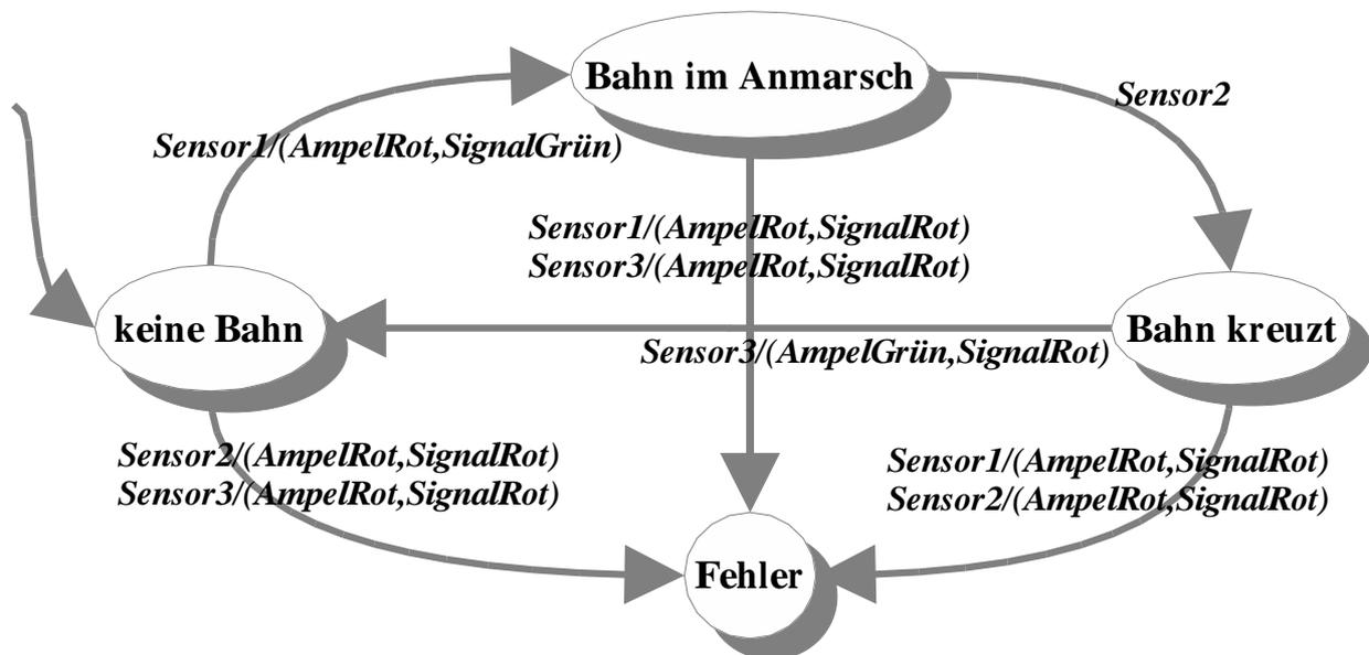
Abbildung 2: Transitionssystem für die Straßenbahnkreuzung. Mehrere Transitionen zwischen jeweils zwei Zuständen sind zu jeweils einem Pfeil zusammengefaßt.
